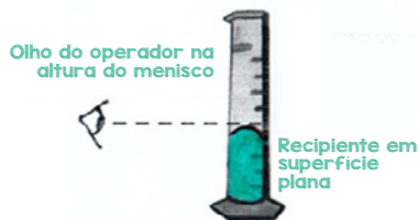
Figura 42. Como ajustar o volume de um líquido observando um menisco convexo
