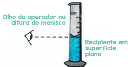
Figura 41. Como ajustar o volume de um líquido observando um menisco côncavo
