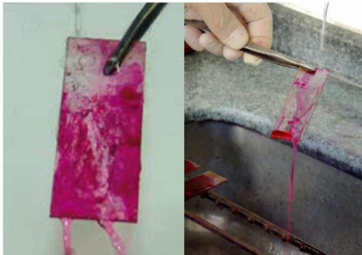
Figura 14 – Lavagem da fucsina em água corrente
