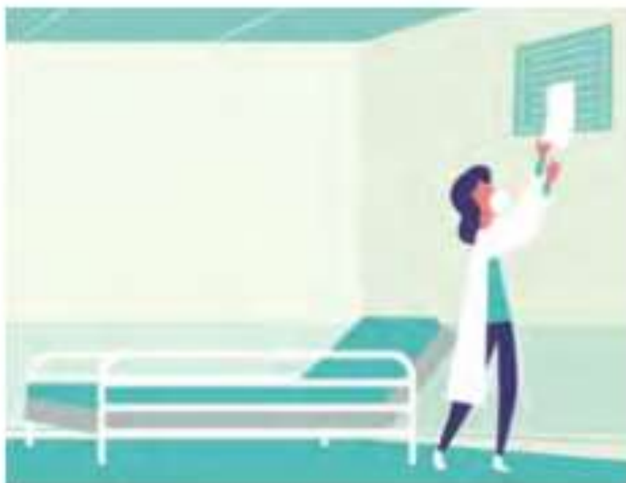
FIGURA 17 Exemplo da utilização de papel para avaliar o funcionamento da pressão negativa no isolamento respiratório.
